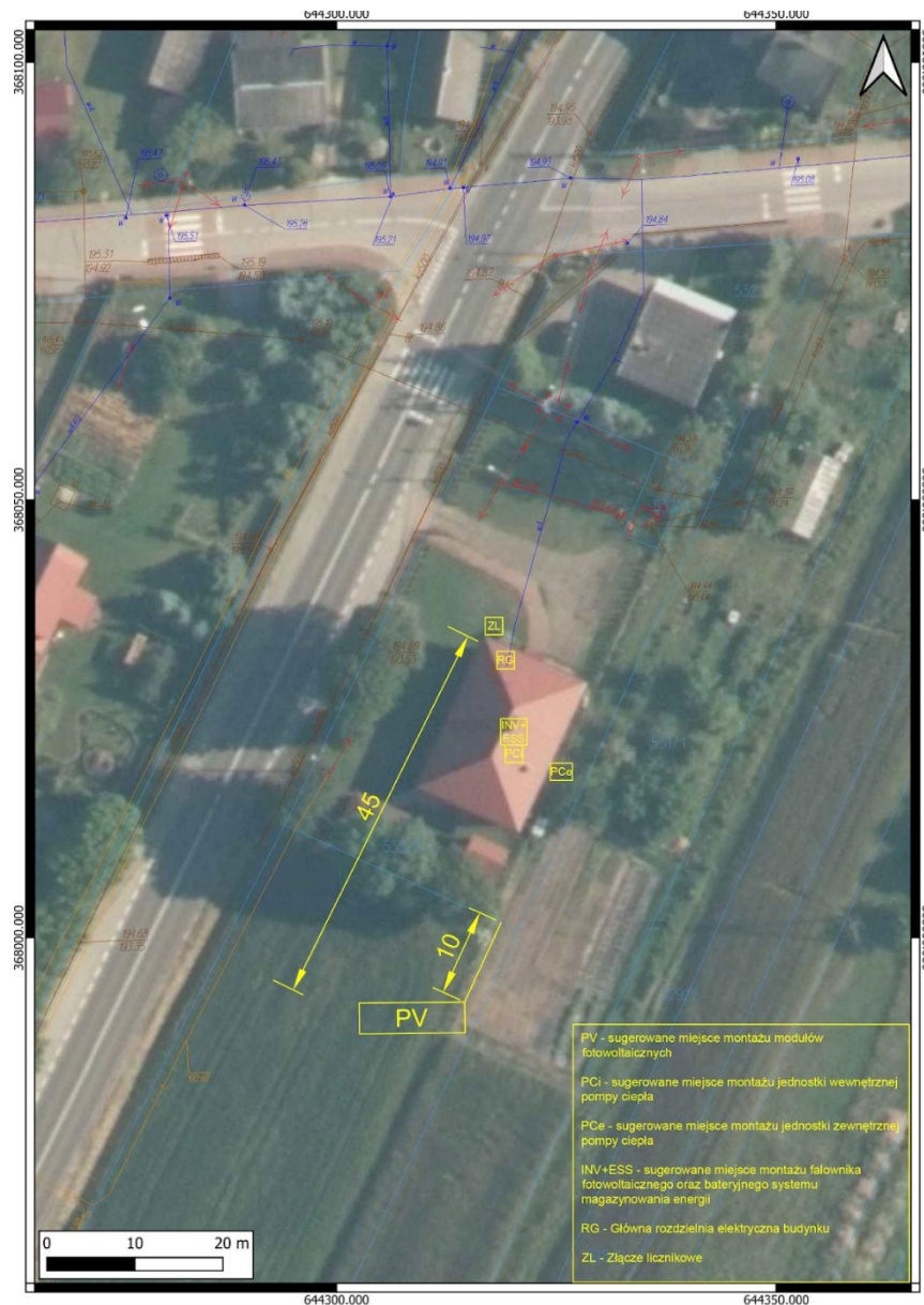
Rysunek 3.2 Lokalizacja złącza licznikowego i rozdzielni głównej oraz preferowana lokalizacja instalacji PV i pompy ciepła.
